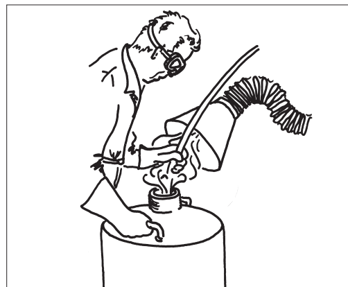
4 Aspirazione di vapori corrosivi
